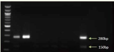
图一：利用PCR方法对细胞样品进行支原体检测的凝胶电泳结果。泳道M：NEB 1Kb DNA Marker；泳道1、2：样品1的细胞裂解液和细胞培养上清；泳道3、4：样品2的细胞裂解液和细胞培养上清；泳道5、6：样品3的细胞裂解液和细胞培养上清；泳道7、8：阴性和阳性实验对照，其中280bp条带为支原体DNA条带，150bp条带为宿主细胞DNA条带。
